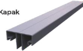
Kış Bahçesi Kapak Profili Ürün Kodu: 2007 Ağırlık kg/m: 0,925 (37 x 63 x 1,8mm)
