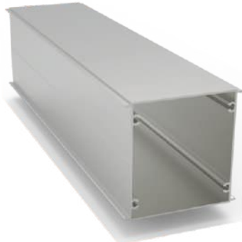
Dikme Profili Ürün Kodu : 2341 Ağırlık kg/m: 3,028 (120 x 110 x 2 mm)
