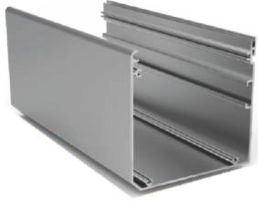
Motor Kutusu Ürün Kodu: 2090 Ağırlık kg/m: 3,075 (146 x 139 x 2,3mm)
