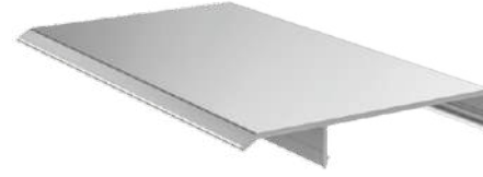
Saçak Profil Kapağı Ürün Kodu: 3179 Ağırlık kg/m: 1,135 (129,95 x 19,63 x 2,5mm)
