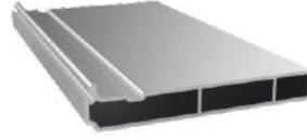
Dikme Ön Kapak Profili Ürün Kodu: 3072 Ağırlık kg/m: 1,170 (78,2 x 40,41 x 1,76mm)
