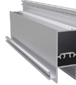
22mm Alt Dikme Profili Ürün Kodu: 3069 Ağırlık kg/m: 1,200 (82,4 x 27 x 1,7mm)
