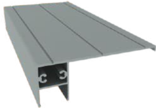
24mm Trabzan Profili Ürün Kodu: 37265 Ağırlık kg/m: 1,285 (38 x 120 x 1,6mm)
