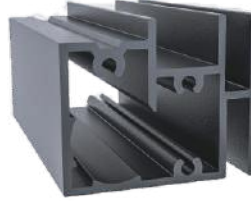
Sabit Yatay Dikme Profili Ürün Kodu: 3042 Ağırlık kg/m: 1,210 (52,3 x 30 x 2mm)
