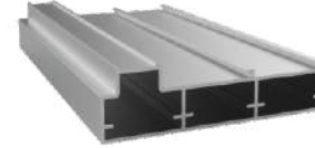
Motor Kutusu Kapak Profili Ürün Kodu: 37271 Ağırlık kg/m: 0,847 (145 x 12,6 x 1,8mm)
