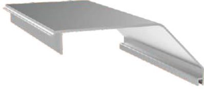
Motor Kutusu Kapağı Ürün Kodu: 3182 Ağırlık kg/m: 1,550 (175,52 x 74,37 x 2mm)
